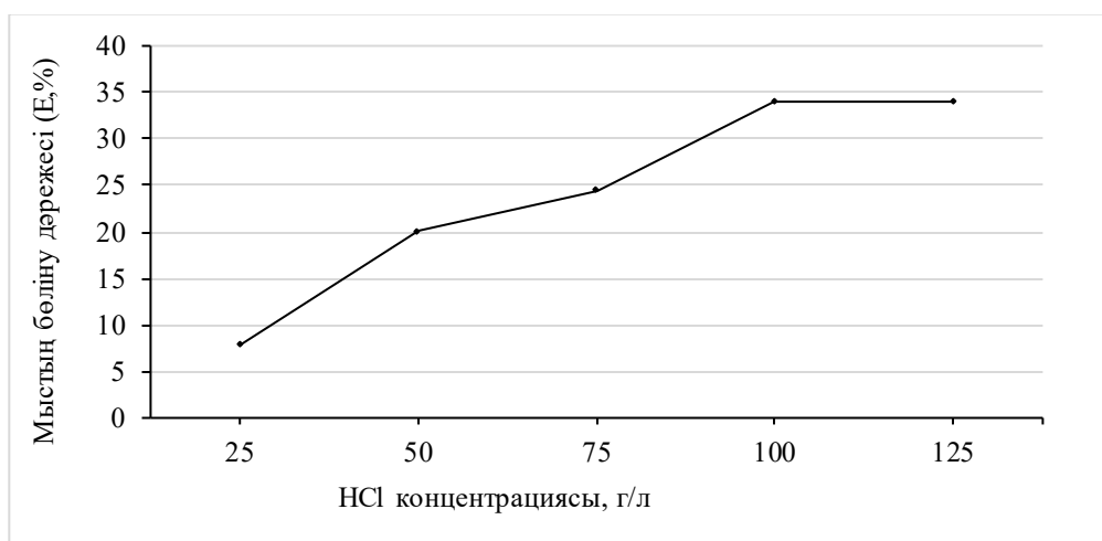
2.3 Сурет – Тұз қышқылы концентрациясының ерітіндіге мыстың өту әсері
